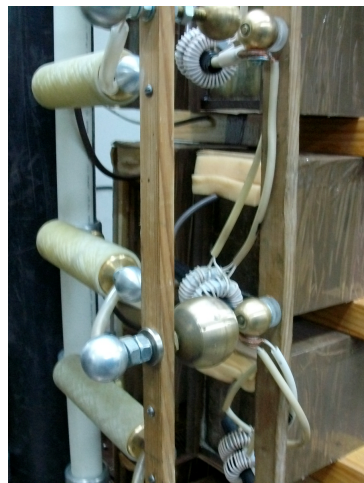
Рис. 3. Вид участка второго блока разрядников с трансформаторами для формирования управляющих импульсов
