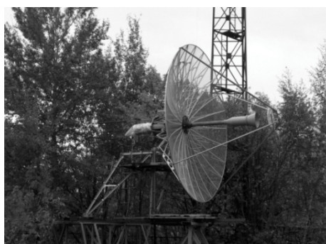
Рис. 10. Излучатель с двухзеркальной антенной
