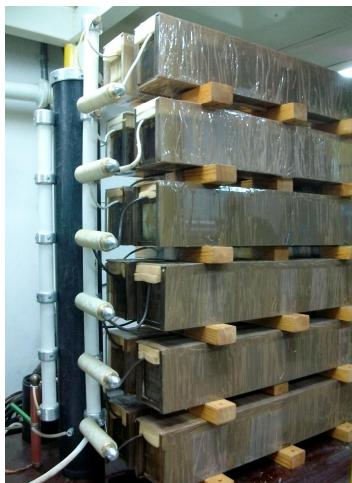
Рис. 2. Колонна генератора с одним блоком разрядников, разделительными сопротивлениями и согласованными нагрузками
