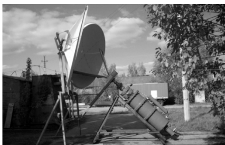
Рис. 8. Излучатель со сдвоенными зеркалами
