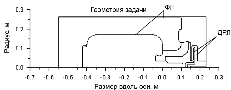
Рис. 5. Расчётная геометрия системы формирования импульсов с нижним положением кольцевого разрядника и проводников ДРЛ
